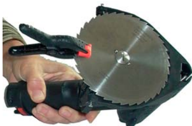
Bild 21 Cirkelkniven fixerad med en griptång
