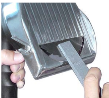
Bild 33 Skägning av cirkelkniven
